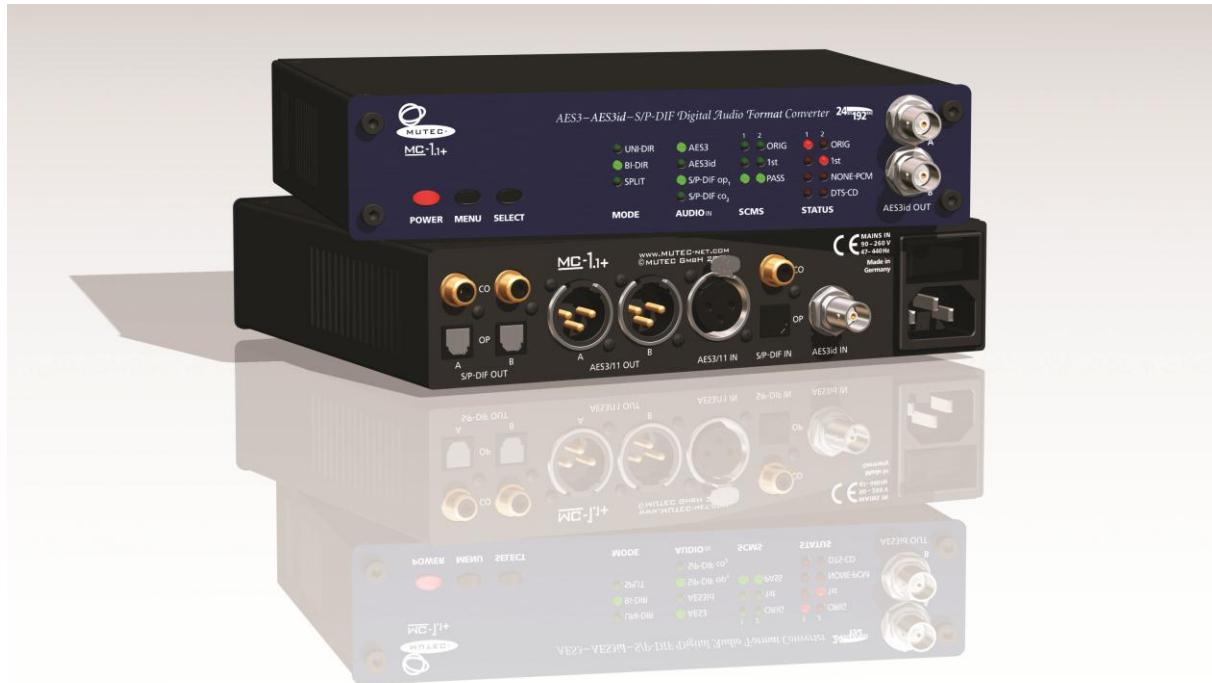
Der MC-1.1+ ist ein digitaler Audioformatkonverter für AES3-, AES3id- und S/P-DIF-Signale und bildet damit *D/I/E* Schnittstelle zwischen konsumier- und professionellen Audiogeräten. Mithilfe neuester Low-Jitter-PLLs und eines störungs-optimierten Schaltungs-Designs regeneriert und stabilisiert der MC-1.1+ eingehende Audiosignale mit bis zu 192,0kHz hörbar.
