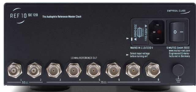
Die Rückansicht des REF10 SE120 unterstreicht die Flexibilität hinsichtlich seiner Anschlussmöglichkeiten
