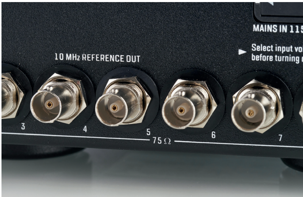
Die 75Ω-BNC-Ausgänge im Detail
