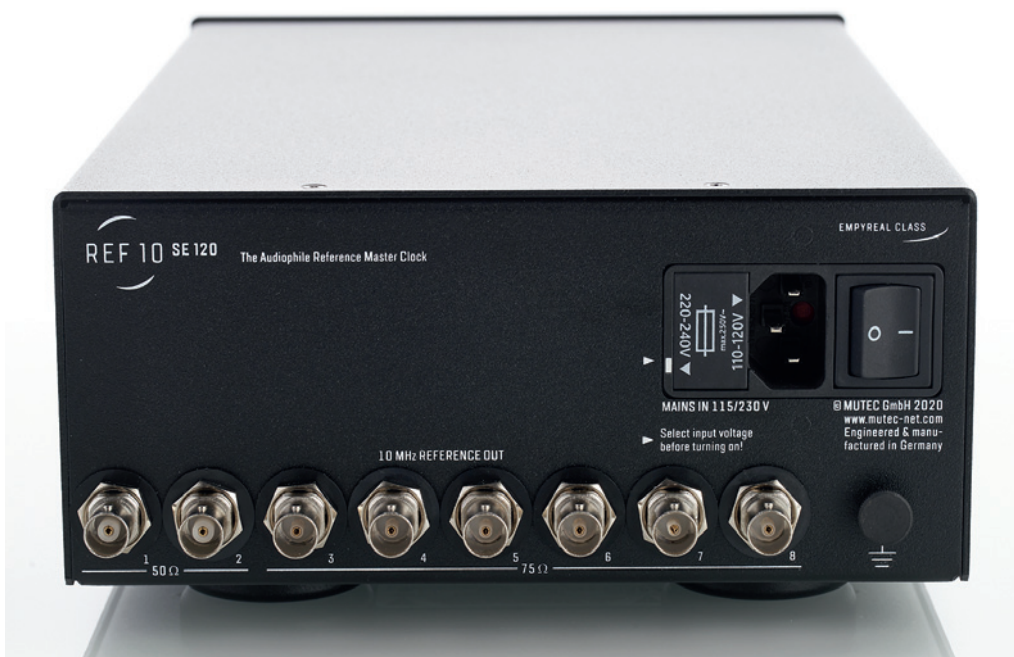
Die Taktausgänge des REF 10 SE120: 2 x BNC 50Ω und 6 x BNC 75Ω
